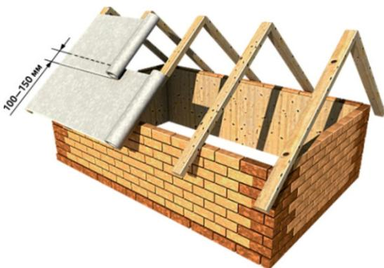
Рисунок 3 Способ укладки гидроизоляционной пленки
